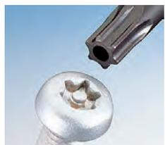
ネジのリセス中央部に「突起」を設け、通常のトルクスドライバーやマイナスドライバーでは差し込めない仕様になっています。タンパーブルーフ・トルクスネジは、主に通信機器やコンピュータなどの「製品の設計上や管理上いじってはいけないところ」に使用されています。
