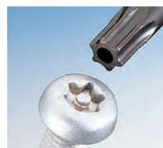
ネジのリセス中央部に「突起」を設け、通常のトルクスドライバーやマイナスドライバーでは差し込めない仕様になっています。タンパープルーフ・トルクスネジは、主に通信機器やコンピュータなどの「製品の設計上や管理上いじってはいけないところ」に使用されています。
