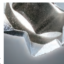
ソケット部の硬度を高く設定し(51HRC)、ギザ部の耐摩耗性を向上させています。
