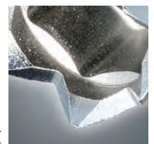
ソケット部の硬度を高く設定し(51HRC)、ギザ部の耐摩耗性を向上させています。
