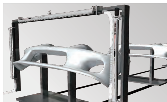
塗装工程前の除電除塵
