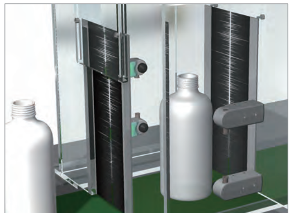
ラベル貼付前のボトル側面の除塵
