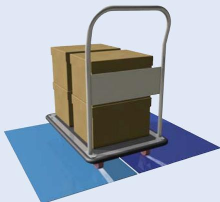
クリーンウォーカーと粘着マットを並べて敷き、荷重をかけた台車をいったん関東ローム層(土埃)の上を通過させてから、マットの上を通過させています。
