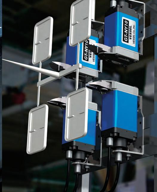
ゲートカット装置や待機ジグに取り付けて樹脂成形品のカットを正確、スピーディーに行う高級ニッパー。24時間稼働や高いカット精度要求に応える豊富なアイテムが揃っています。
