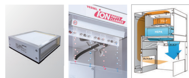
HEPAフィルタを内蔵ユニットで交換可能 生成したイオンをダウンフローワイドなエア吹き出し口 エア循環式で外部への排気がない
