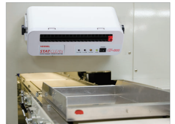
搬送ベルトコンベア上の除電
